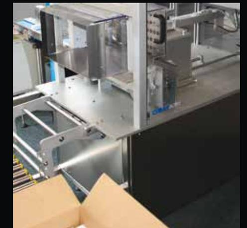
È una macchina incartonatrice semiautomatica progettata per incartonare astucci e altri oggetti di forma parallelepipedale. Basata su principi semplici e funzionali, si presenta con un aspetto compatto e dimensioni contenute, peculiarità che la rendono facilmente adattabile come fine linea. La sua versatilità consiste nella rapidità di cambio formato che può essere effettuato in pochi minuti. DEM-01 offre all'utente anche la possibilità di registrazione in memoria di ogni formato utilizzato.
